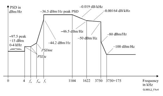
Figure A.4/G.993.2 – VTU-O DS1 transmitter PSD mask
